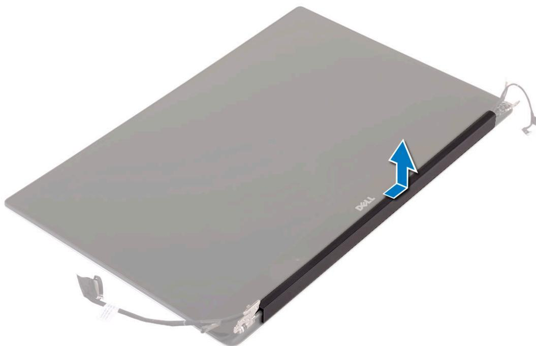
6. Para remover o módulo da antena:
