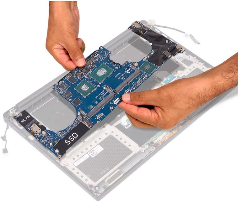
4. Conecte os cabos da porta do adaptador de energia, do alto-falante, da placa de controle do teclado, do touchpad e da tela sensível ao toque à placa de sistema.
